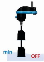
A minimális folyadékszint elérésekor a szivattyú lekapcsol.
